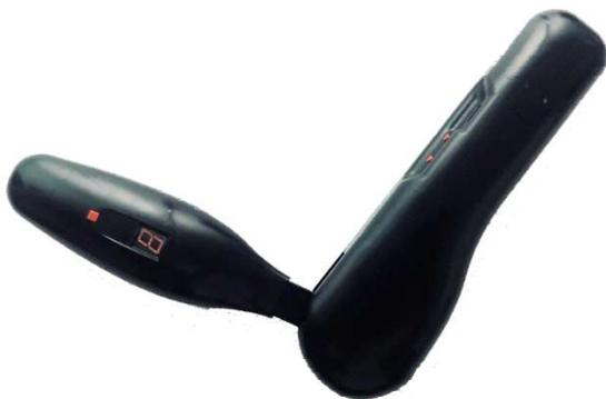
アクティブギプス腕用は上肢に障害がある方を対象として開発された電動ロック機能を有する肘ヒンジ継手です。主に手の平に装着する圧力センサーからの信号により装着者の必要なタイミングで肘関節の保持を行います。
